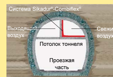
Герметизация вентиляционных воздуховодов с помощью Sikadur®-Combiflex®
