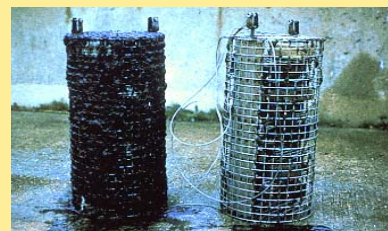
Sikadur®-Combiflex® после 12 месяцев погружения в сточную и питьевую воду.
