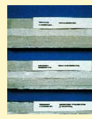
Sikadur®-Combiflex® после воздействия озона в течение 3-х месяцев
